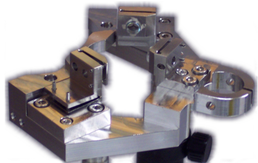
Abbildung 4.1: Foto des Ringresonators vor dem Einbau in die Vakuumkammer
